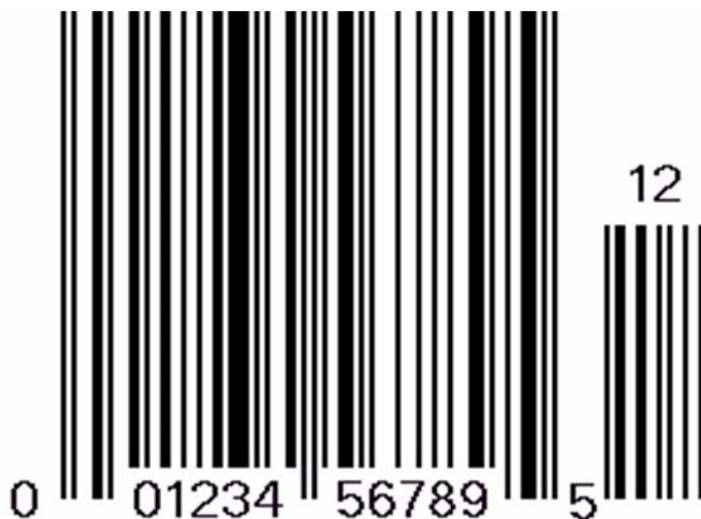
Slika 2.1.9 UPC-A. simbol sa dvije dodatne cifre za periodičnost
