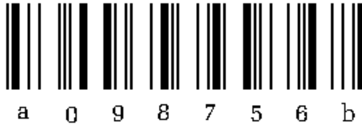
Slika 2.1.25 Primjer Codabar simbola
