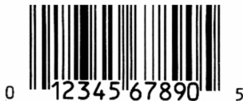
Slika 2.1.6 Skraćeni simbol U.P.C. koda – verzija A
