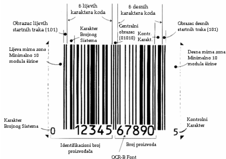
Slika 1.4. Kompletan simbol U.P.C koda – verzija A
