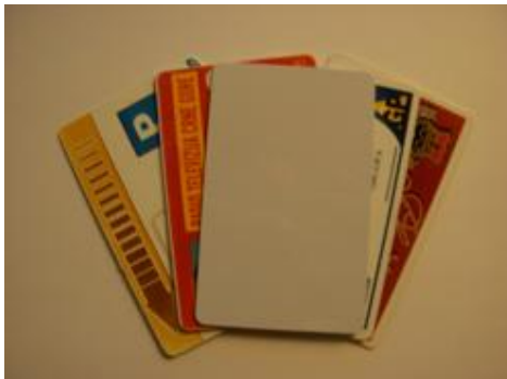
Slika 4.2.5 Mifare MF1ICS50 kartica, primjer kartice sa dijeljenom memorijom.
