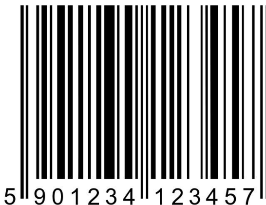
Slika 2.1.11 Primjer U.P.C./EAN-13 simbola.
