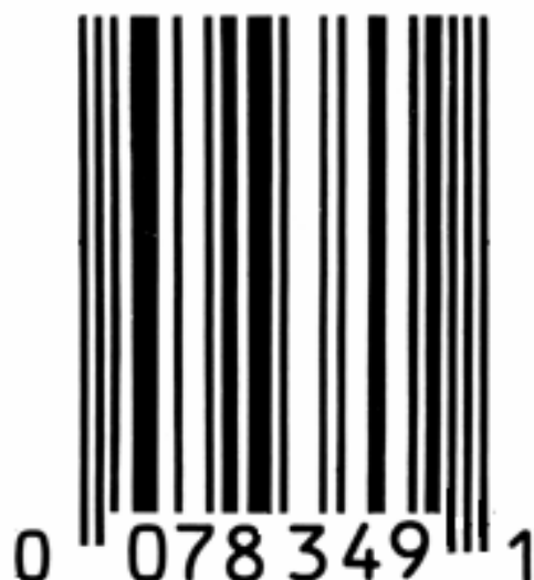
Slika 2.1.8. Simbol U.P.C. trakastog koda – verzija E
