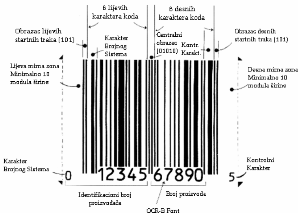
Slika 2.1.5. Kompletan simbol U.P.C koda – verzija A
