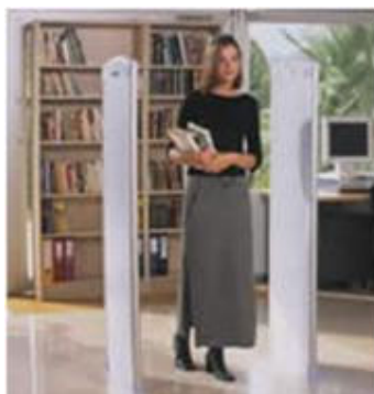
Slika 3.11.2 Vrata u biblioteci opremljena RF čitačima
