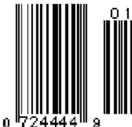
Slika 2.1.10 UPC-E simbol sa dvije dodatne cifre za periodičnost
