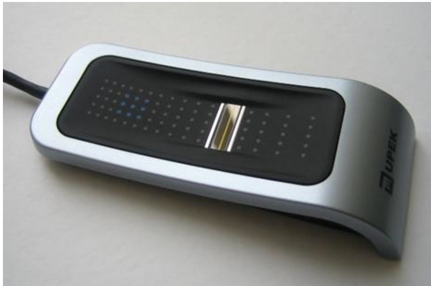
Slika 5.2.25 Termički čitač otiska prsta
