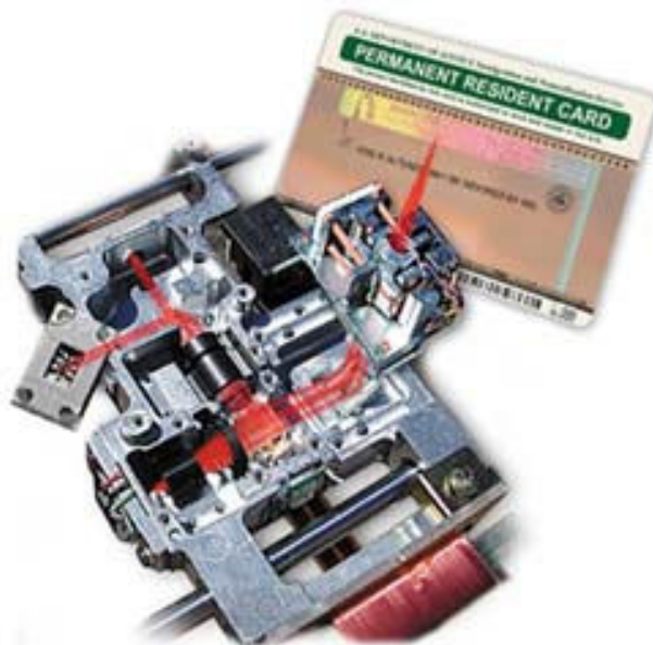
Slika 2.2.3 Optička kartica i njen čitač
