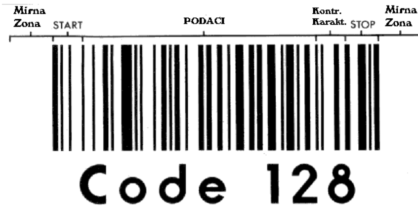
Slika 2.1.19 Struktura Code 128 simbola
