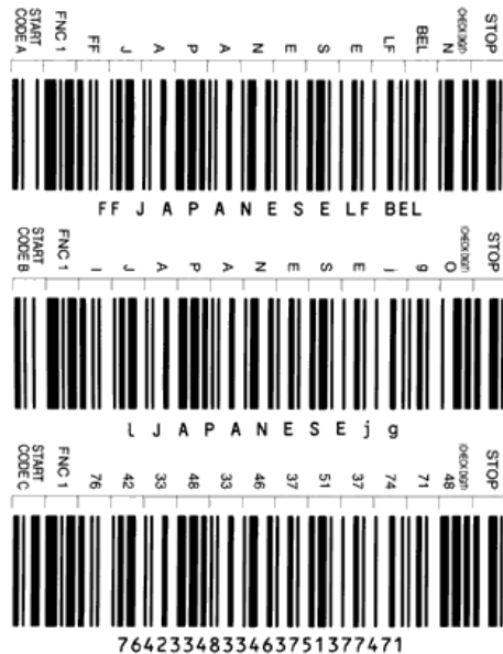
Slika 2.1.21 Code 128 simboli koji imaju identične karaktere podataka a različite START karaktere kodiraju različite nizove podataka.
