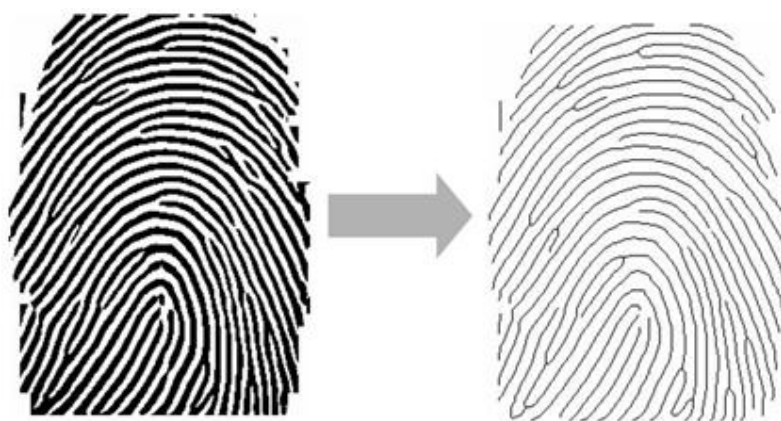
Slika 5.2.15 Stanjivanje brazdi u binarizovanoj slici otiska prsta
