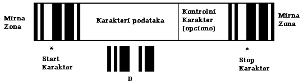
Slika 2.1.22 Struktura Code 39 simbola
