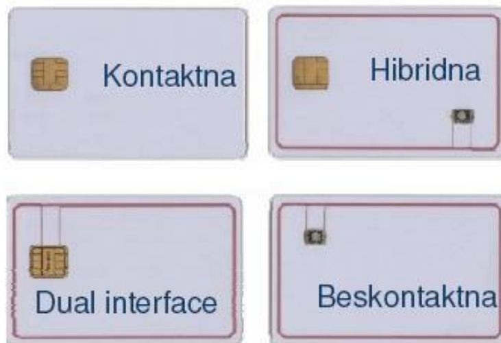
Slike 4.2.2 Interfejsi za razmjenu podataka sa okruženjem kod pametnih kartica
